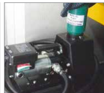
▲ Electric oil refilling/emptying pump Pompe électrique de remplissage et vidange pour l'huile
