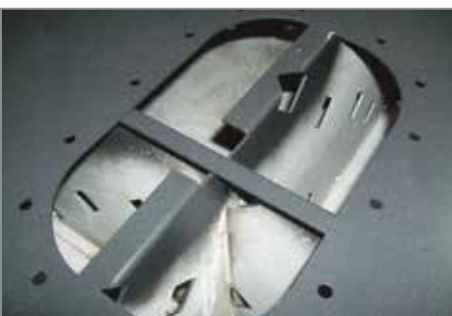
▲ Internal baffles for fuel sloshing control Brise-lames pour éviter tout déplacement excessifs du carburant dans le réservoir
