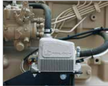
▲ Engine water heater Préchauffage eau
