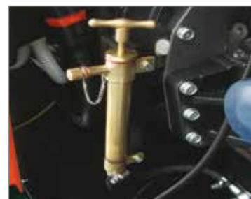
▲ Oil extraction pump Pompe de vidange huile
