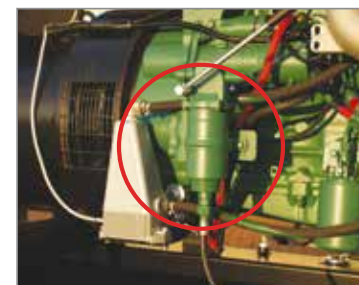
▲ Oil extraction pump Pompe de vidange huile
