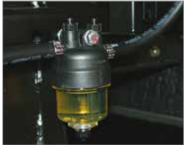
▲ Water separator filter Filtre séparateur eau
