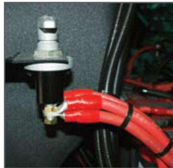
▲ Battery isolator switch Interrupteur coupe-batterie
