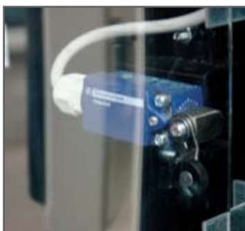
Power terminal board protection switch Interrupteur de protection bornier de puissance
