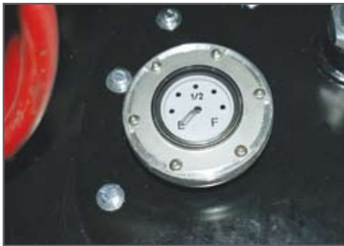
▲ Mechanical fuel level reading placed next to the filling point Lecture mécanique niveau carburant placé à côté du point de remplissage
