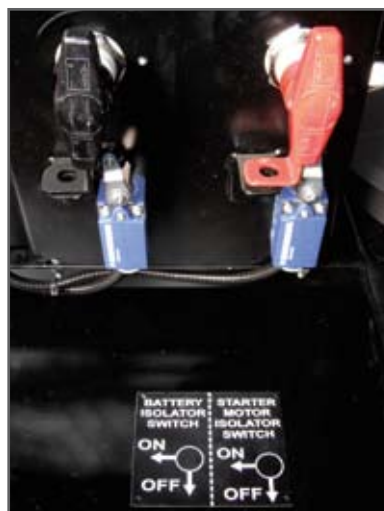
◀ Lockable disconnectors for starter motor and battery (mining applications) Déconnecteurs verrouillables démarreur et batterie (applications minières)
