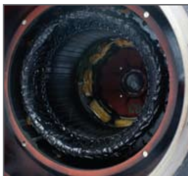
▲ Alternator anticondensation heater Résistance préchauffage alternateur
