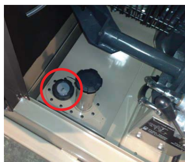
▲ Mechanical fuel level indicator Indicateur mécanique de niveau gasoil
