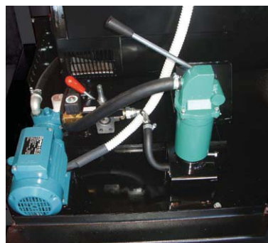
▲ Automatic fuel refilling kit Kit de remplissage automatique
