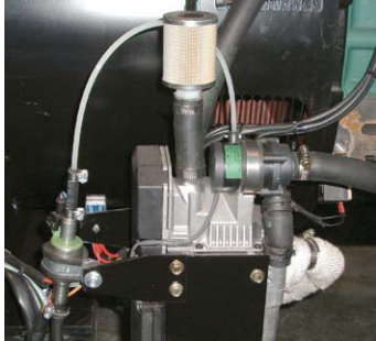
▲ Diesel-powered heater Préchauffage alimenté par diesel
