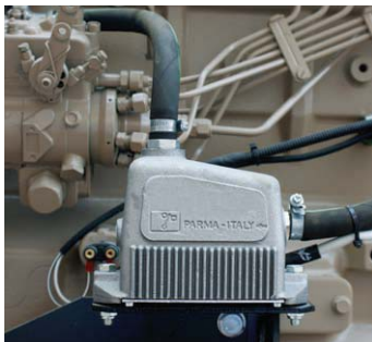
▲ Engine water heater Préchauffage eau
