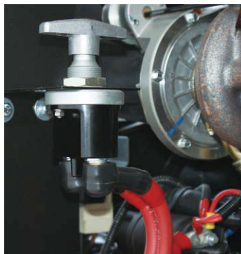
▲ Battery isolator switch Interrupteur coupe-batterie
