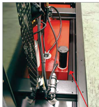
▲ Bunded tank Reservoir avec bac de rétention
