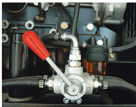
▲ Divertor valve kit for external fuel tank Vanne déviatrice pour réservoir extérieur
