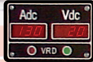
DSP Welding Voltmeter / Ammeter & Optional VRD indicator
