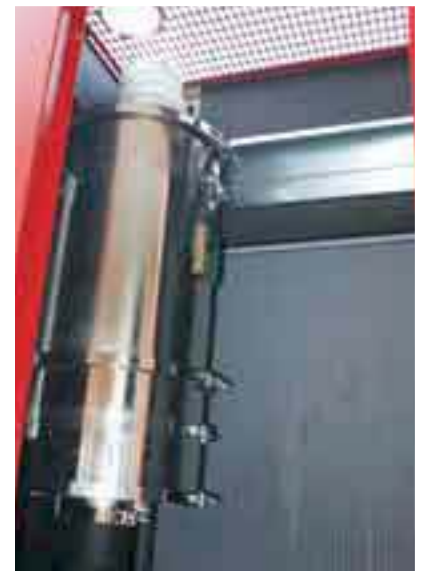
🔍 Catalytic anti-particulate filter for lower exhaust emissions Silencieux avec filtre anti particules
